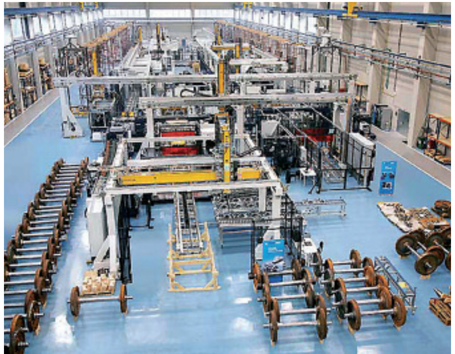
Errusiako TVSZ enpresarako bogie eta muntatutako ardatzen fabrikaziorako linea.
